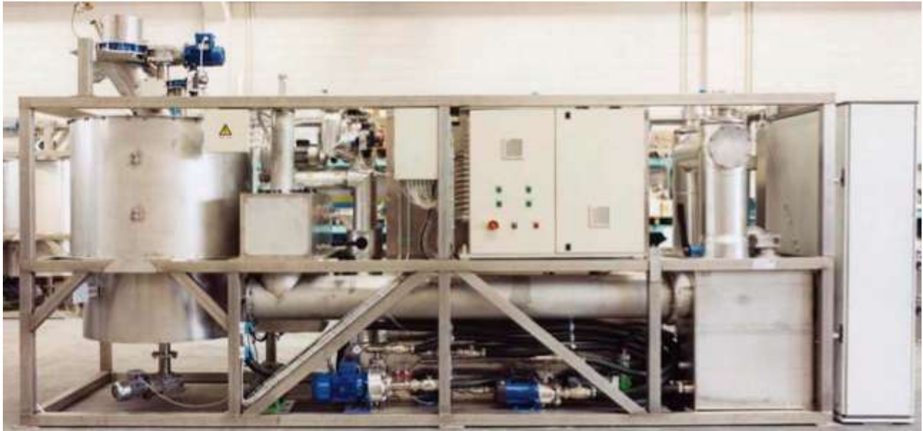
Impianto da 150 Kwe con processo di pirolisi – dimensioni un container da 40' (mt. 12,20x2,44)
